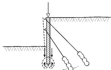
شکل ۷-۶-۴ نمونه‌ای از حالت حدی گسیختگی قائم دیوارهای توکار.
